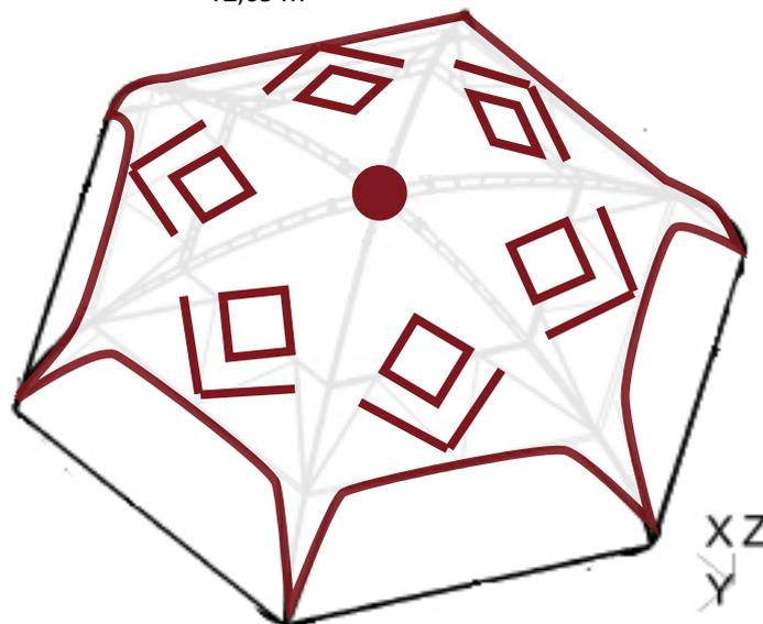
KIOSK AVEC SA TOILE AVEC VUE DE LA STRUCTURE MÉTALLIQUE EN TRANSPARENCE (dans la réalité la toile est opaque )
